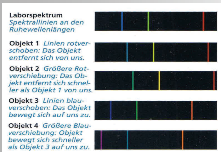
Abb. 2: Darstellung von Dopplerverschiebungen im Vergleich zum Spektrum im Ruhezustand.
